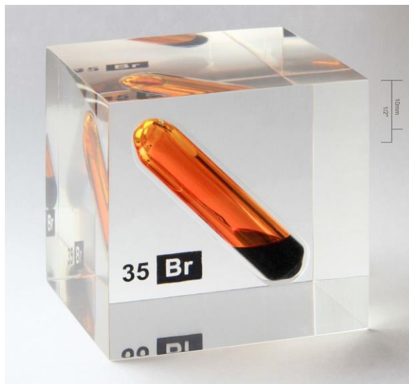
Obr. 11.3: Ampule s bromem zalitá do akrylátové pryskyřice
