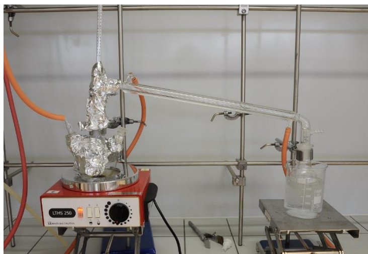
Obr. 8.1: Aparatura pro pyrolýzu polystyrenu
