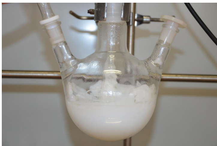
Obr. 5.3: Nežádoucí výsledek polymerace vypnuté v průběhu reakce
