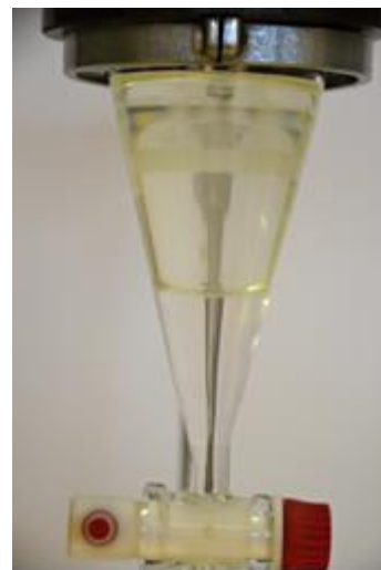
Obr. 4.1: Oddělené fáze při čištění styrenu
