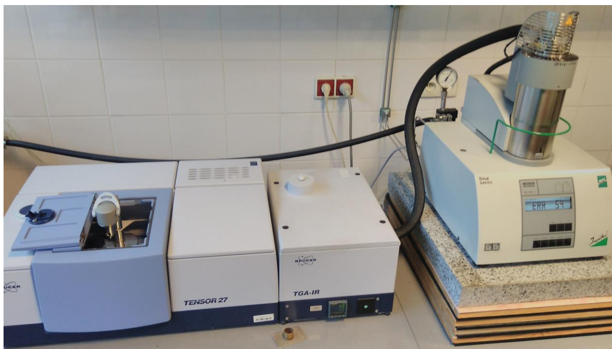
Obr. 11.1: Propojení termické analýzy a infračerveného spektrometru
