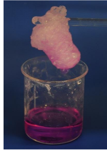
Obr. 3.3: Produkt vzniklý neřízenou polymerací
