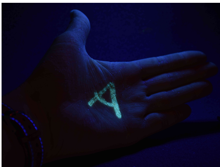
Obr 26: Fluorescence připravených biokompatibilních uhlíkových nanočástic při 366 nm.
