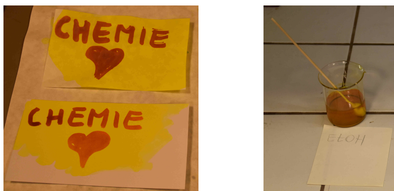
Obr. 16: Nápis provedený roztokem jedlé sody na filtračním papíru (vlevo nahoře) a kreslícím kartonu (vlevo dole) po vizualizaci pomocí extraktu z kurkumy (vpravo).
