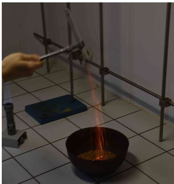
Obr. 4: Hoření čerstvě připraveného pyroforického železa
