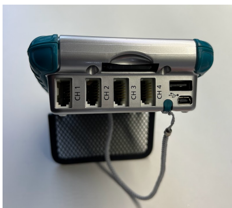
Obr. 60: Vstupy na porty RJ-12 na jednotce LabQuest.
