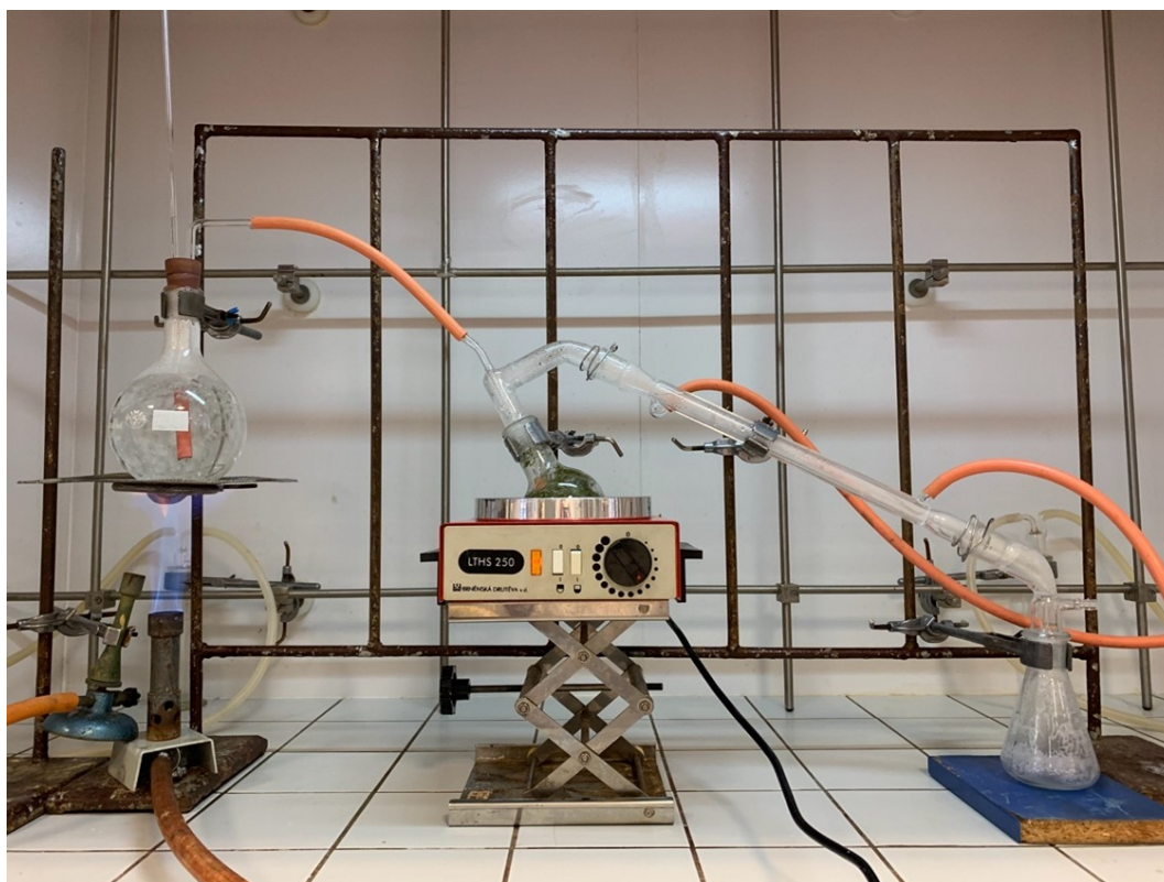
Obrázek 35: Destilační pro destilaci s vodní parou na aparatuře s vyvíječem vodní páry.
