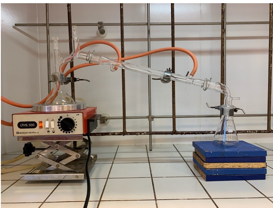
Obrázek 33: Příprava vzorku pro destilaci s vodní parou (nahore) a aparatura pro tuto destilaci (dole).
