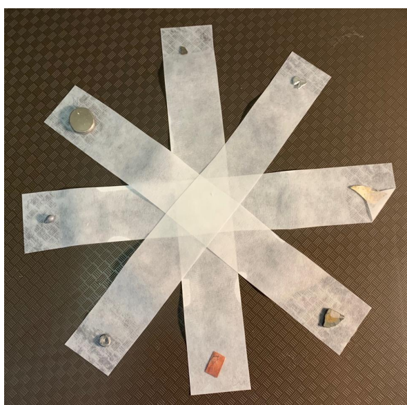
Obr. 79: Měření napětí článků s poločlánky na plastové podložce.
