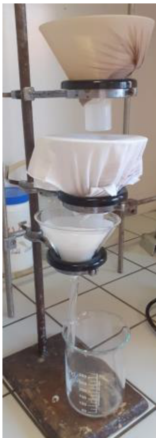
Obr. 30: Filtrační aparatura pro kaskádovou filtraci vzorku vody s mikroplasty. Vrchní filtr je ze silonky, prostřední z látkového kapesníku a spodní z filtračního papíru.
