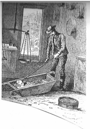
7 Příprava sklářského kmene v 19. století. Kmenář míchá dávku kmene v neckách překopáváním. Jsou vidět váhy a síta na suroviny.
