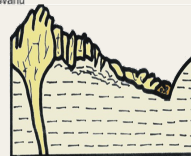
Flyšoidní vrstvy uložené proti sklonu svahu
