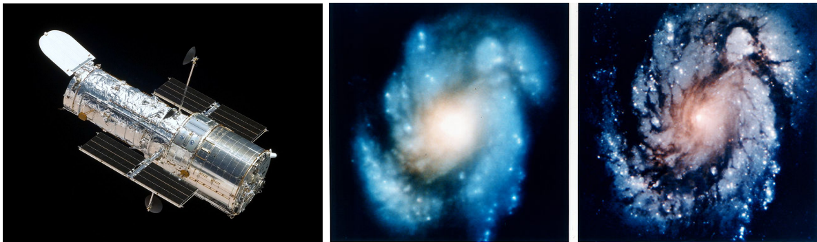
Obrázek 5.9: Hubbleův kosmický dalekohled. Základní data: tvar válce o délce 13 m, šířce 4,3 m a hmotnosti téměř 12 tun. Optický systém Ritchey-Chrétien (typ Cassegrain) s primárním zrcadlem 2,4 m, sekundárním zrcadlem 30 cm. Cena 1,5 mld dolarů. Na snímcích vpravo nahoře je možné srovnat obraz galaxie M100 před korekcí obrazu a po ní. Převzato z wikipedia.
