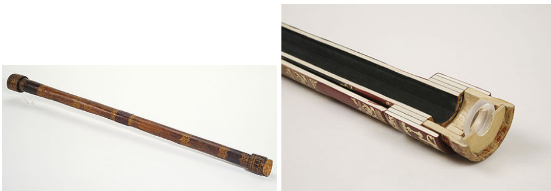
Obrázek 2.11: Vlevo: Galileův bohatě zdobený dalekohled. Vpravo: Řez replikou Galileova dalekohledu, která ukazuje strukturu a složení částí dalekohledu. Zdroj: http://blogs.telegraph.co.uk ; http://brunelleschi.imss.fi.it/galileopalazzostrozzi/ .
