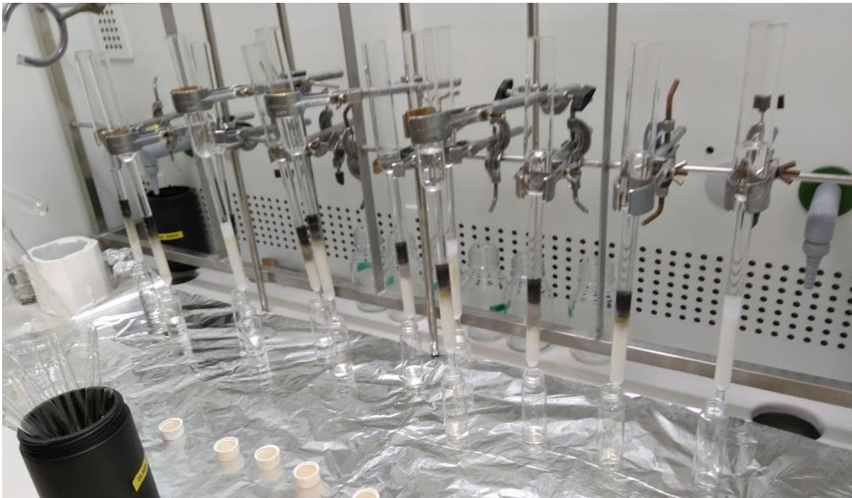
Obr. 5: Eluce vzorku z kolony se silikagelem modifikovaným kyselinou sírovou
