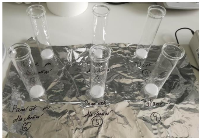
Obrázek 6: Vzorky v extrakčních patronách
