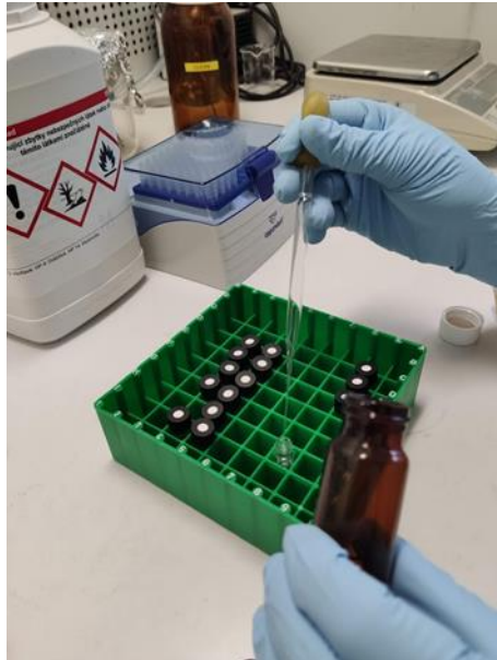
Obrázek 13: Převodění zhuštěných vzorků do minivialek pomocí pasterovy pipety
