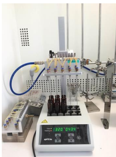
Obrázky 11 a, b: Zhušřování vzorků v koncentrátoru Digital Dry Bath
