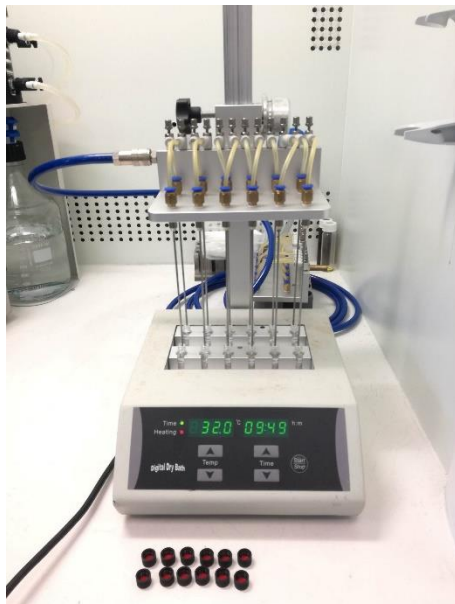
Obrázek 14: Zahuštění vzorku v minivialekách
