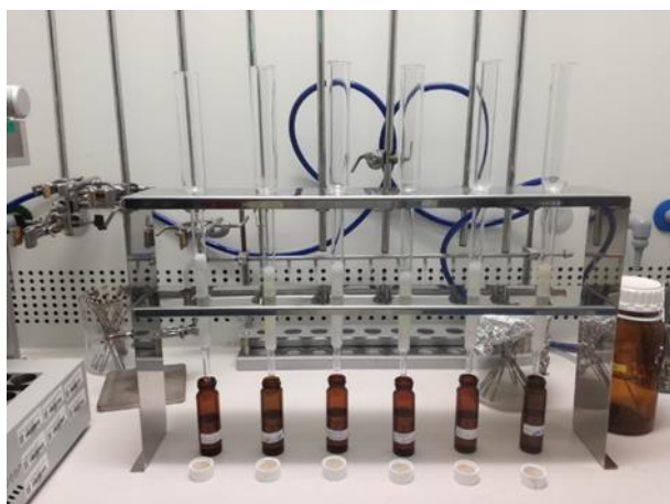
Obrázek 10: Kolony s předchystanými vzorky k čištění
