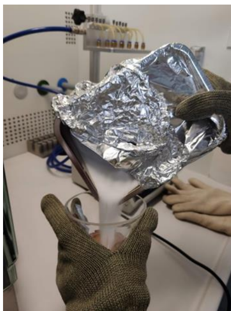
Obrázek 9: Přesypání silikagelu do skleněné nádoby
