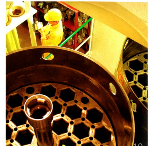
▣ Transportní zásobník paliva ve skladu čerstvého paliva
