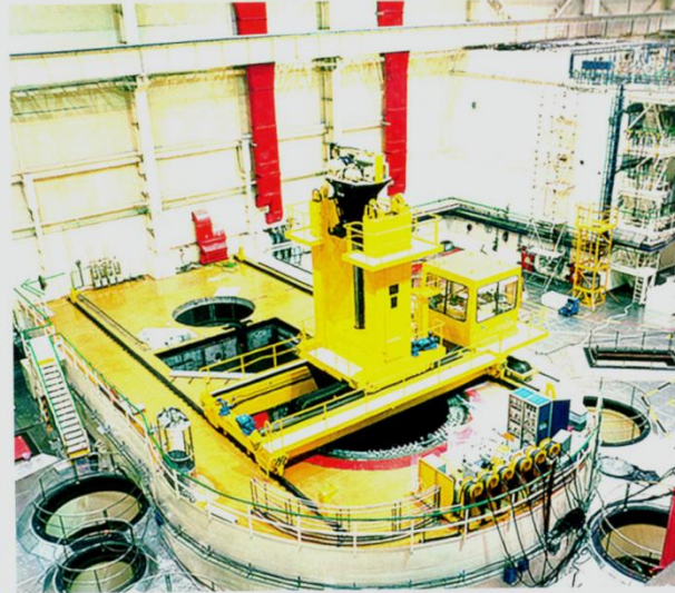
▣ K zavezení paliva do reaktoru slouží speciální stroj
