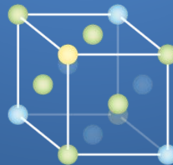
kubická plošně centrovaná mřížka – dutiny s oktaedrickou a tetraedrickou symetrií
