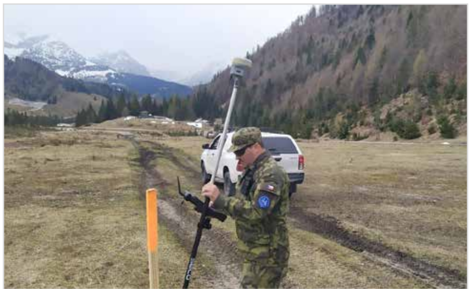
Obr. 4 K měření mimo jiné sloužil přijímač GNSS Trimble R12i umožňující díky technologii kompenzace náklonu i měření v šikmé pozici
