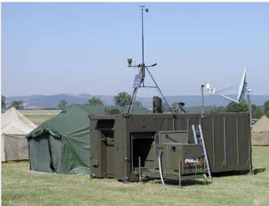
Obr. 17 Rozvinutá mobilní hydrometeorologická stanice Oblak
